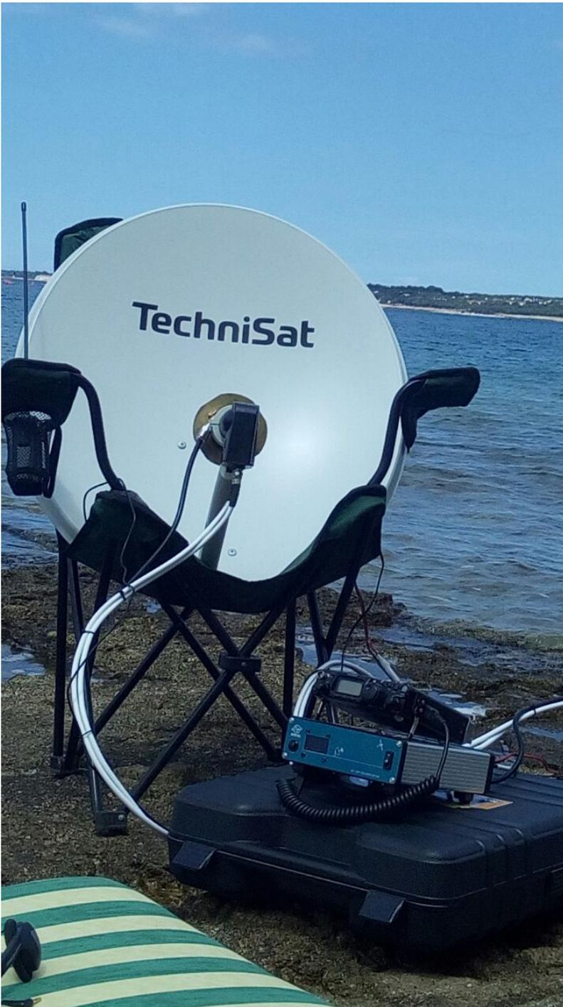
Tatsächlich bietet DXPATROL nun das Model GROUNDSTATION an, das in einem Gehäuse alle nötigen Komponenten enthält um auf QO-100 qrv zu werden:
