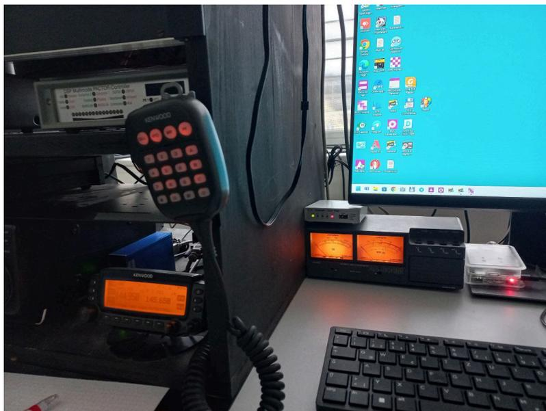
An der Station **OE9XRK** in Feldkirch wurde ein Xnet-Digipeater auf Basis eines Raspberry Pi installiert. Der Digipeater ist über Hamnet mit OE9XFR und dem Packetradio-Netzwerk verbunden. Eine weitere Verbindung besteht über Packet 9k6 mit dem Digipeater Schellenberg OE9XFR. Der Winlink Packet RMS OE9XRK-10 ist nun direkt über das Flexnet-Autorouting erreichbar und auch im Igate zu finden.
