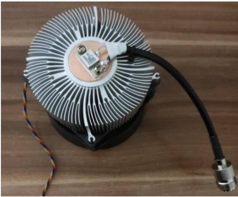
Beim anschließenden Leistungstest zeigte sich, dass der Dummyload rund 70 W Dauerleistung thermisch gut verkraftet. Der verbaute Widerstand ist zwar bis 250 W spezifiziert, diese Leistung hält der Aufbau aber nur für wenige Sekunden aus – genau richtig für kurze Tests, aber nichts für Dauerbetrieb.
