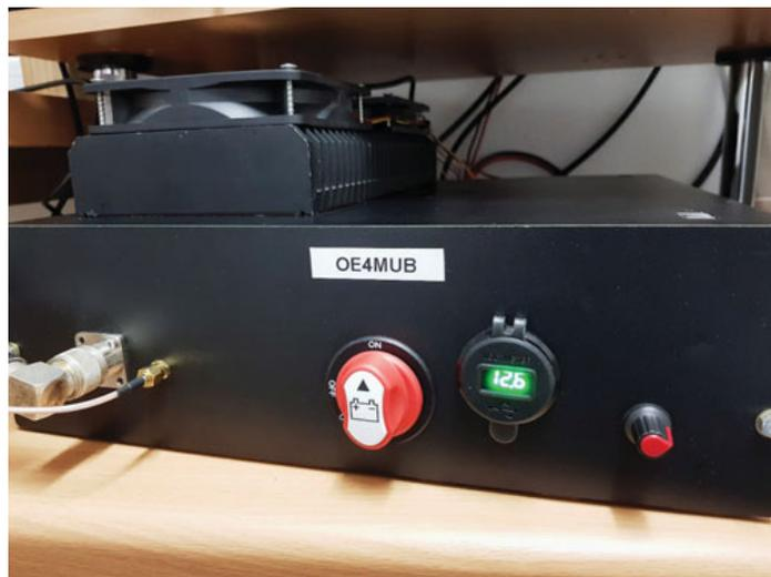
50W PA eingebaut im PC Gehäuse
