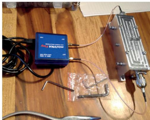
Messaufbau mit dem Mini-VNA Tiny
